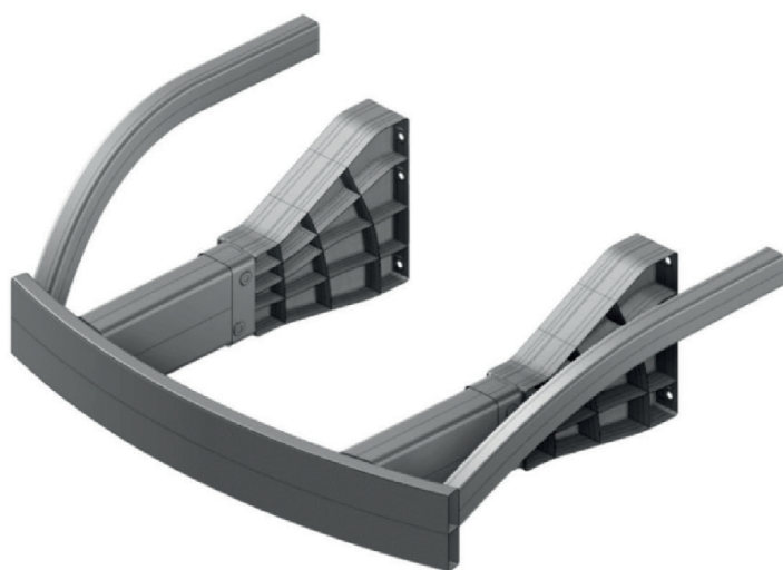
Estructura frontal fabricada completamente en aluminio y diseñada dentro del proyecto FlexCrash. Simulación del comportamiento del perfil extruido mediante AVFF
